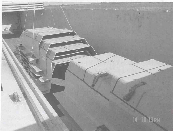
Store modular som skal verna om installasjonar på havbotn, om bord i båten som skal frakta dei.
