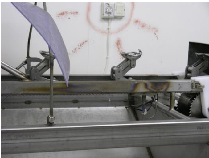
Nærbilde av den automatiserte produksjonseininga som kuttar krabben i 4 ulike produkt. "Skålene" viser kor krabben blir lagt før han går vidare på bandet og blir oppdelt.
